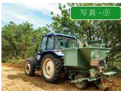
存です。機械利用の先進地である南大東島や沖永良部ではすでにトラクターのアタッチメントとして機械で二芽苗を植付けるビレットプランタ(写真⑨)が浸透し、種苗供給の組織構築など新たなさとうきび作りの体制が構築されつつあります。徳之島でも同じ様に大規模農家に向けたビレットプランタの普及と中小規模農家に向けては、もう少し手軽に二芽苗を植付ける方法の模索などこれからはさとうきび産業の方向性を探りながら皆様と共にさとうきび生産の維持拡大に邁進していくことを希望いたします。そこで今後ともご協力よろしくお願いします。
