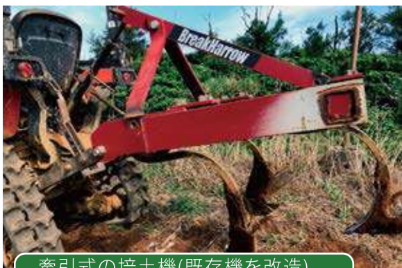
牽引式の培土機(既存機を改造)
